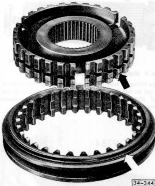
**Abb. 7 Schiebemuffe und Synchronkörper für 2. und 3. Gang zusammenbauen**
