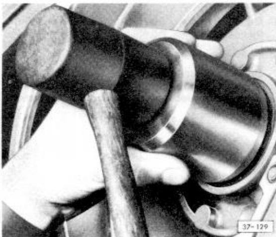
Abb. 2 Wandlerdichtring ansetzen mit VW 792
