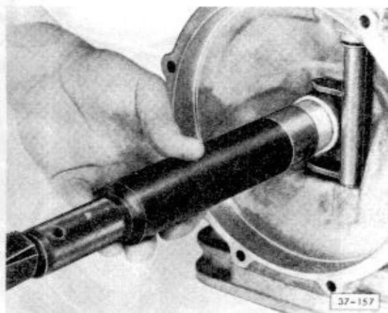
Abb. 8 Führungsbuchse ansetzen und mit VW 244 b auftreiben
