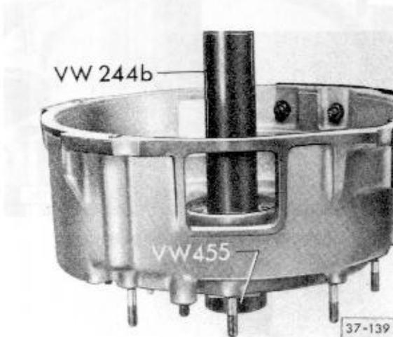
Abb. 12 Rillenkugellager für Kupplungsträgerscheibe eindrücken oder eintreiben
