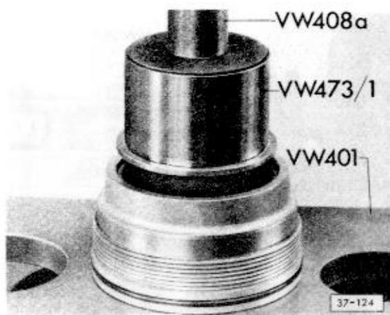
Abb. 18 Außenring für Kegelrollenlager einpressen
