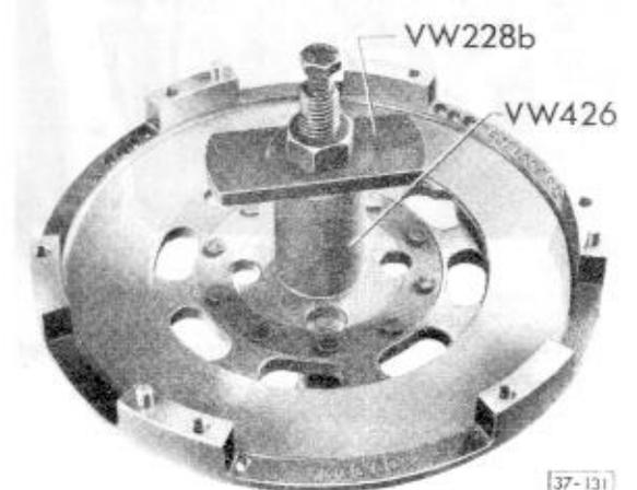
Abb. 4 Dichtring und Nadellager für Antriebswelle ausziehen. Auch bei eingebauter Trägerscheibe möglich.
