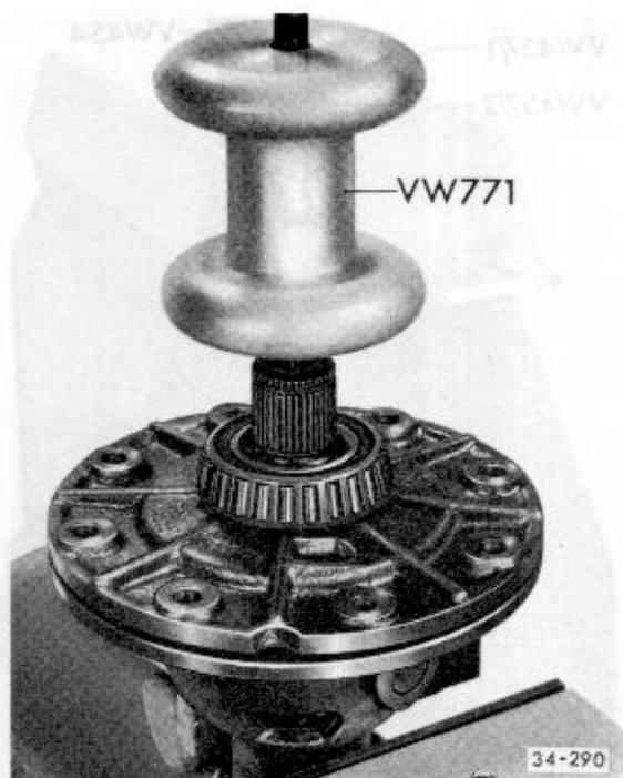
Abb. 3 Deckel vom Ausgleichgetriebegehäuse abziehen
