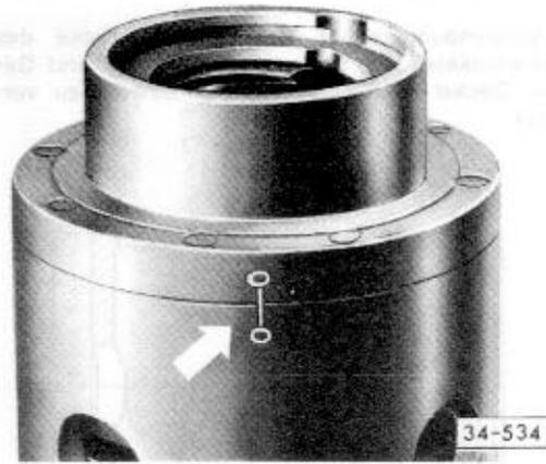
Abb. 3 Kennzeichnung des Deckels zum Gehäuse
