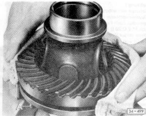
**Abb. 3** Tellerrad auf ca. 100° C erwärmen und aufsetzen
