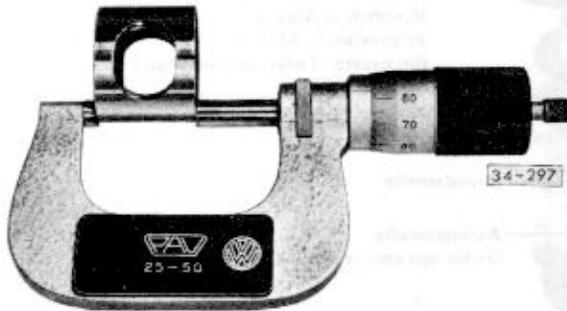
Kürzeste Abstandhülse – Ersatzteil-Nr. 004517241 – mit einer Mikrometerschraube ausmessen und Istmaß auf die Hülse mit einem Elektroschreiber oder ähnlichem aufschreiben. Die Hülse ist dann immer als Meßhülse zu verwenden und mit der Meßvorrichtung zusammen aufzubewahren.
