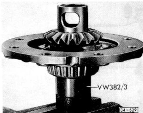
1 – Großes Ausgleichkegelrad (kurze Welle) mit **beiden** Anlaufscheiben in den Deckel einsetzen, Spannhülse VW 382/3 montieren, und Kegelrad fest gegen den Deckel spannen.
