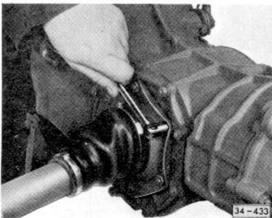
**Abb. 3** Lagerdeckel abschrauben und Achsrohr komplett mit Gelenkschutzhülle abnehmen
