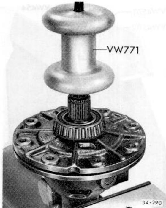
Abb. 3 Deckel vom Ausgleichgetriebegehäuse abziehen
