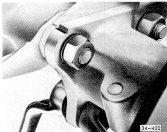
5 – Lage der Federstrebe zum Achsrohrlagerflansch mit einem Meißel in der Flucht der Kerbe des Achsrohrlagerflansches markieren. Beim Einbau vorherige Lage wieder herstellen.
