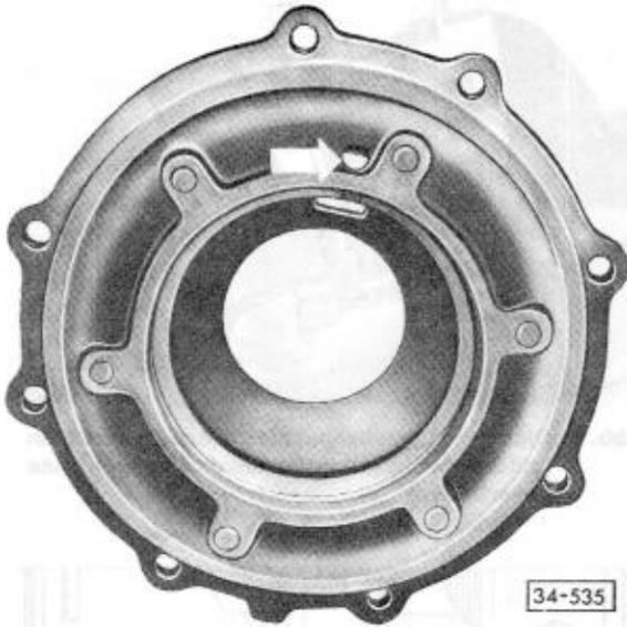
Abb. 1 Nur Deckel für Achsantrieb mit Ölbohrung einbauen
