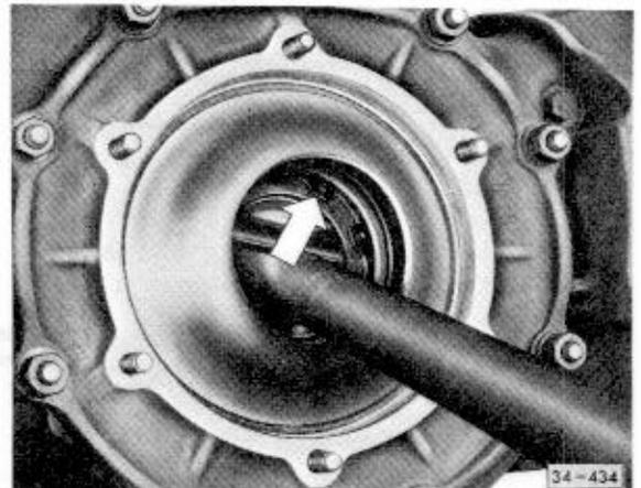
**Abb. 4** Sicherungsring (Pfeil) mit Spitzzange (handelsüblich) abnehmen
