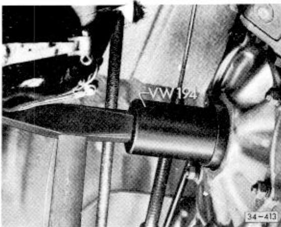
1 – Neuen Dichtring bis Anschlag eintreiben. Raum zwischen den Dichtlippen mit Mehrzweckfett füllen.
