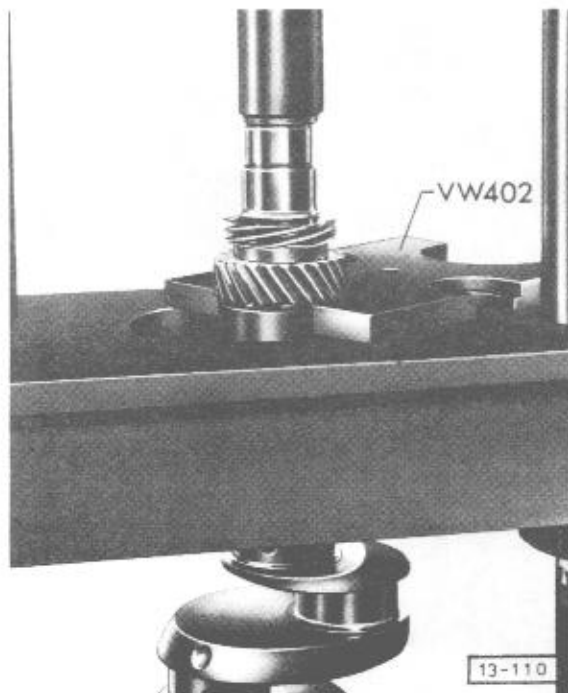
Abb. 7 Kurbelwellenrad mit Zündverteilerantriebsrad ausbauen
