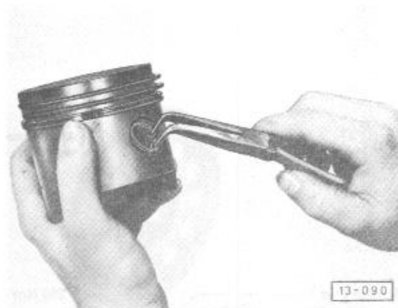
Abb. 5 Sicherungsring aus- und einbauen 13-090
