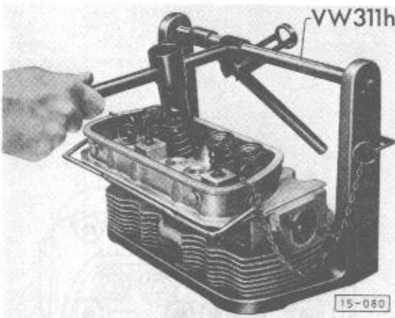
Abb. 5 Ventildedern aus- und einbauen
