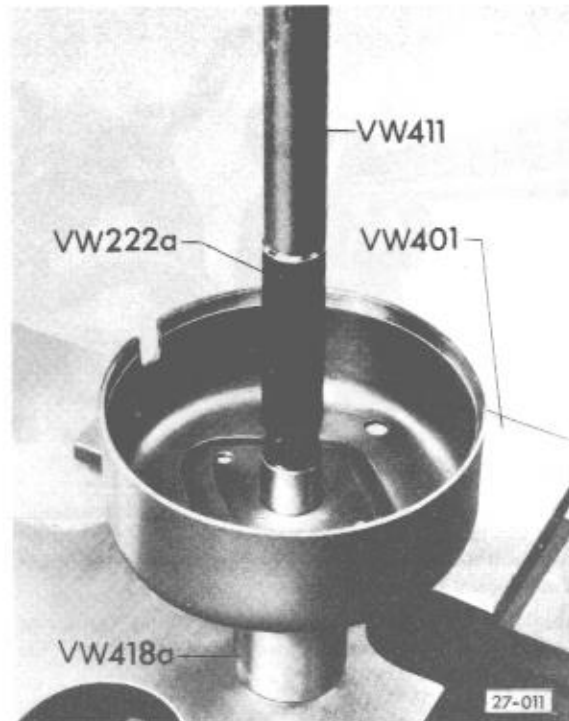
Abb. 4 Buchse im Lagerschild ersetzen
