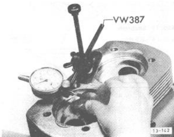
Abb. 15 Ventilführungen prüfen Kippspiel max. 0,8 mm
