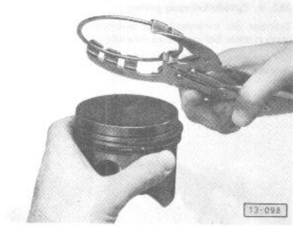
Abb. 1 Kolbenringe aus- und einbauen
