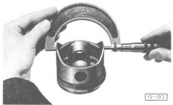
Abb. 6 Kolben \varnothing prüfen
