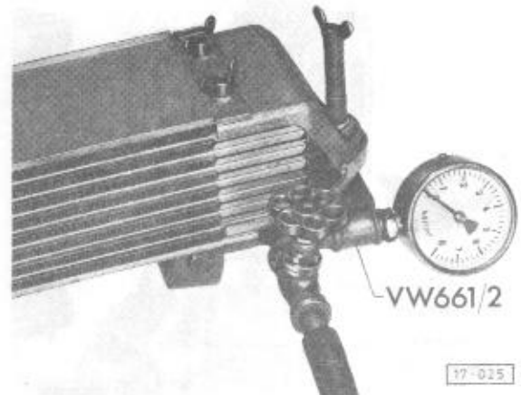
Abb. 4 Ölkühler auf Dichtigkeit prüfen
