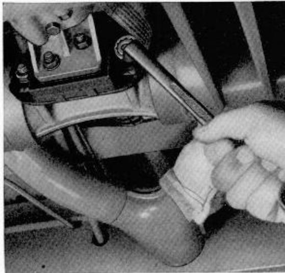
14 - Befestigungsmuttern am Gummi-Metall-Lager der vorderen Getriebeaufhängung entfernen.
